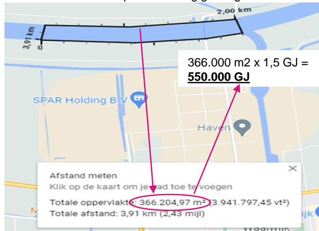
Afbeelding 8 – Voorbeeld meettechniek aquathermie
